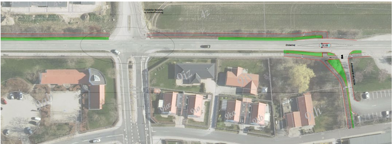
Figur 2. Enkeltrettede stier langs Ørstedvej (løsning B) hen til Viby Skole med krydsningshelle
